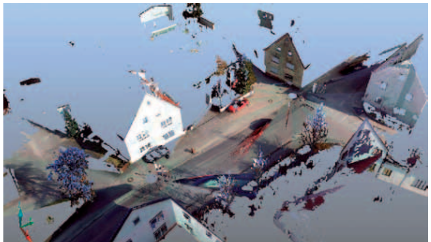
BILD 16: 3-D-Punktwolke in Farbe, erzeugt aus zwei Scanpositionen
