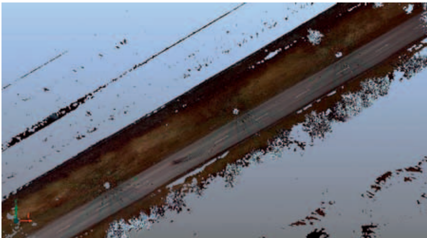
BILD 24: Draufsicht auf eine 3-D-Farbpunktcloud mit drei Standpunkten des Laserscanners FIGURE 24: Plan view of a 3D multi-coloured point cloud with three locations of the laser scanner
