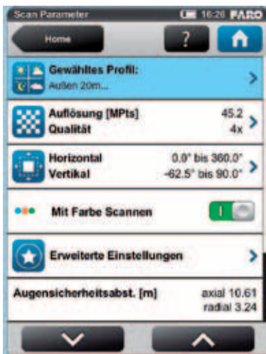
BILD 15: Touchscreen des FARO Focus 3D
