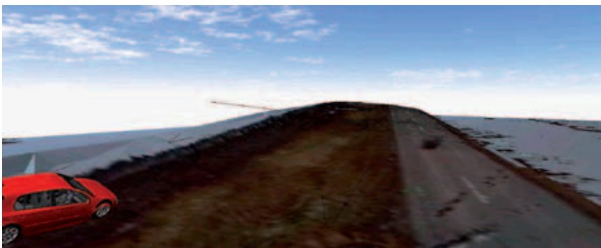
BILD 25: Überlagerung des Luftbilds aus Faro Scene mit der ausgedünnten, triangulierten Punktcloud in PC Crash FIGURE 25: Superimposition of the aerial image from Faro Scene with the thinned-out, triangulated point cloud in PC Crash
